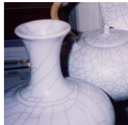
図6 カナダ・ビクトリアの陶器店で見た 壺表面の斜めの割れ（図5とは逆方向の 斜め割れができている）
