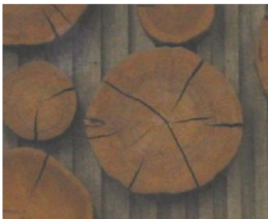
図8 木材に発生する放射状割れ
