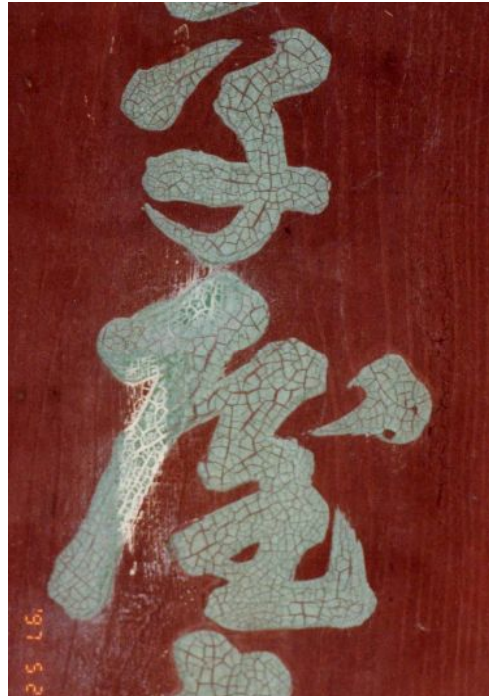
長野市で見かけた老舗の看板の文字のき裂（1997年，繰返し分割型）
