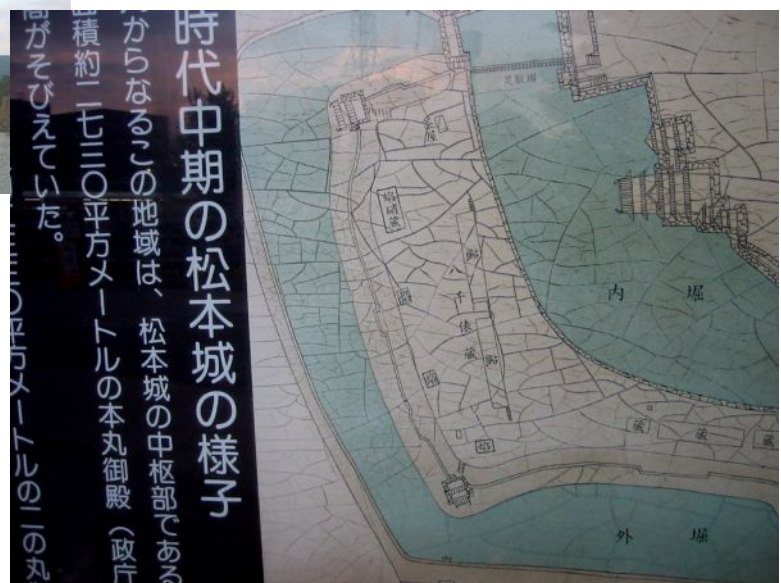
松本城の案内板の割れ（2006年8月） 繰返し分割型
