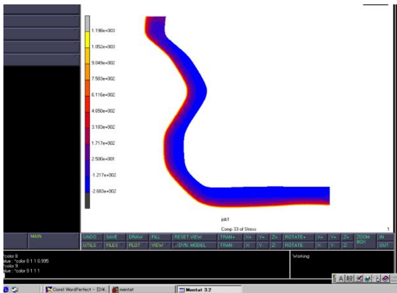
Fig.6 冷却時の接線方向応力（左下）およびひずみ（右上）の断面分布
